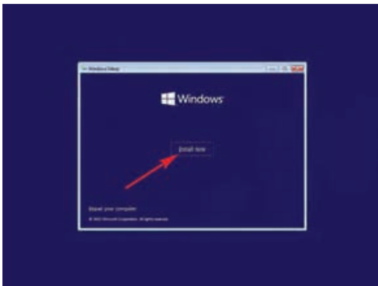
Gambar 3.44 Tangkapan Layar Proses Eksekusi Instalasi Windows 10
